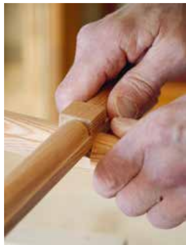
Tärningen i spröjsens mitt är ett typiskt karaktärsdrag för ett fönster från 1700-talet.
